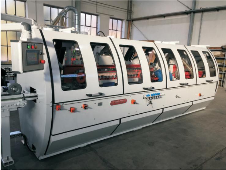
Kombinierte Hobelmaschine und Auftrennsäge für besonders hohe Leistungen und Lamellenqualität.
