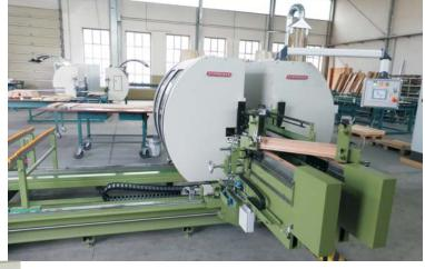
Als **Doppelend-Profiler** mit 3 bis 4 Aggregaten je Seite zum exakt recht-winkeligen Abkürzen und stirnseitigen Profilieren mit Nut & Feder sowie ev. zusätzlicher Stirnfase.
